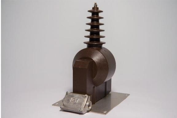
Es un transformador tipo seco para conexión entre línea y neutro. El núcleo y las bobinas están encapsuladas con resina epóxica que proporciona excelentes propiedades dieléctricas, resistencia mecánica, resistencia a los rayos ultravioleta y de la erosión en el exterior del transformador. Larga vida mecánica y eléctrica.
